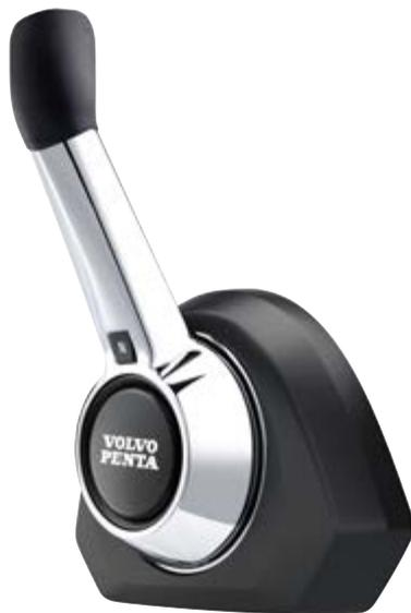
Commandes montées latéralement avec systèmes électroniques (EVC) pour la série D3/D4.
